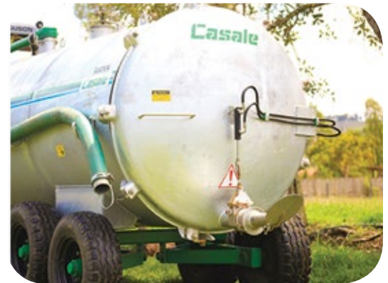
Válvula gaveta com acionamento hidráulico e abertura total da tampa traseira para limpeza e manutenção.
