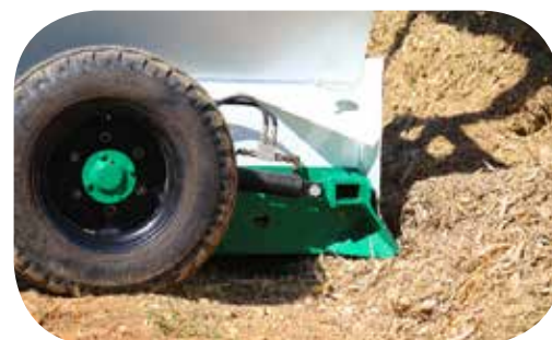
Sistema hidráulico que permite a parte traseira da máquina baixar ao nível do solo.
