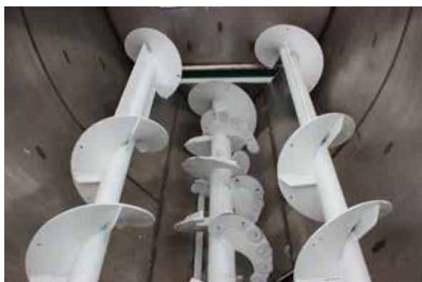
Rosca inferior extra reforçada, segmentada e com facas removíveis.
