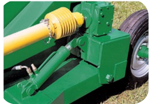
Cilindro hidráulico de regulação da altura do corte.
