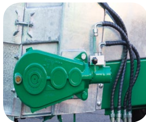
Motor redutor hidráulico: permite precisão no controle da distribuição e maior vida útil.
