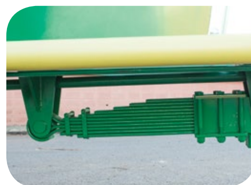
Cabeçalho exclusivo com sistema de suspensão por feixe de molas.
