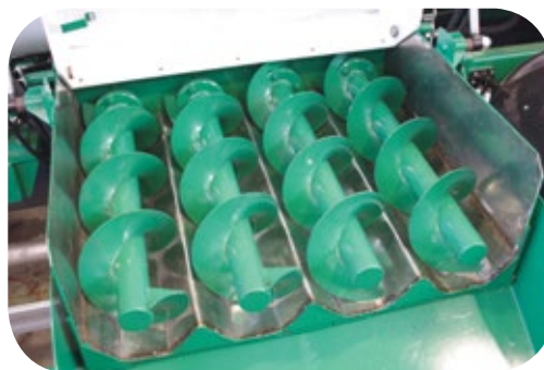
Bico de descarga com 4 roscas rápidas.
