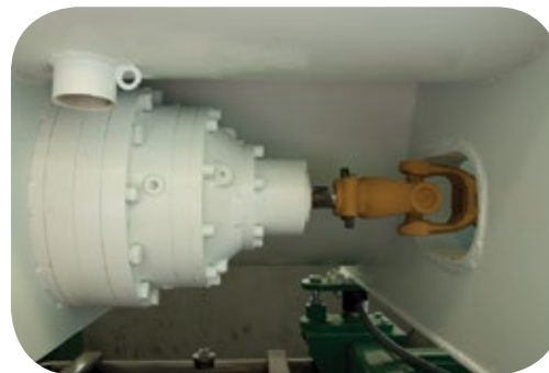
Transmissão principal por meio de redutor planetário.
