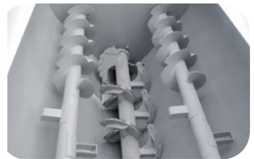
Rosca inferior extra reforzada, segmentada y con cuchillas removibles.
