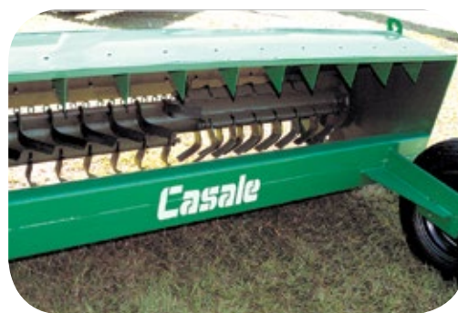
Rotor con 42 cuchillas.
