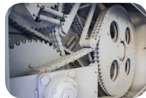
Sistema de transmisión con engranajes y correas dobles en los modelos arriba de 20 m 3 .
