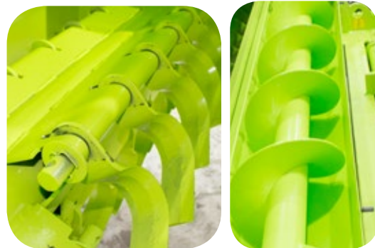
Facas do rotor recolhedor com revestimento de carbeto e rosca transportadora.
