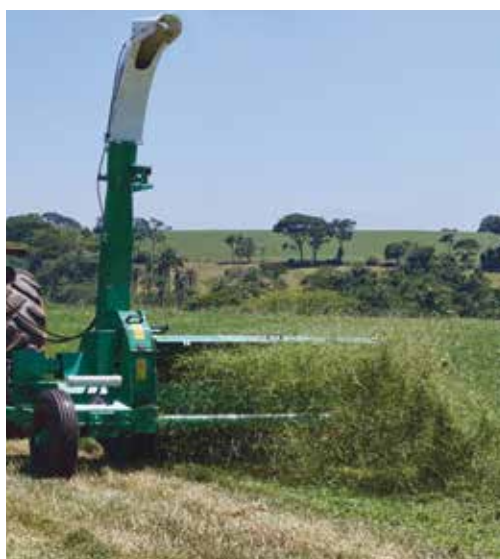
Sistema que permite a pré-secagem com posterior recolha da forragem por meio de rotor recolhedor.
